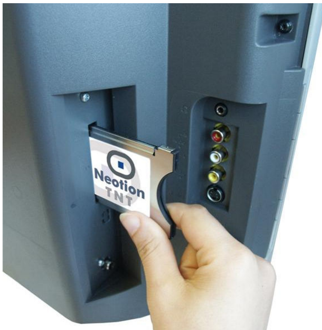
Le NEOTION Pocket du bouquet Neotion TNT s'insère facilement dans l'interface commune DVB-CI des téléviseurs à TNT intégrée.
